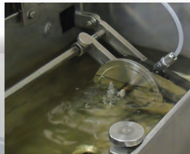
Bubble Point Testing per ARP 901
